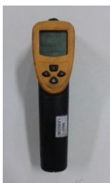
Termômetro infravermelho, de 20°C a 530°C
