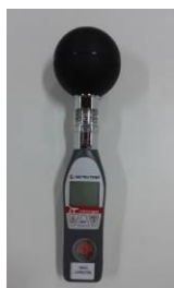
Termômetro de Globo ITWTG2000, de 0°C a 50°C, precisão +/- 0,6
