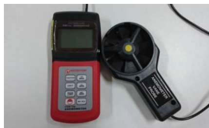
Anemômetro ITAN 720, 0,4 a 45 m/s, precisão +/- 0,2
