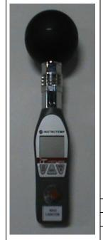
**Descrição:** Este medidor manual mede a temperatura do ar, temperatura global e umidade para fornecer o índice de pressão do calor para uso no controle de atividade física em ambiente quente para limitar o perigo de danos relacionados ao calor.
